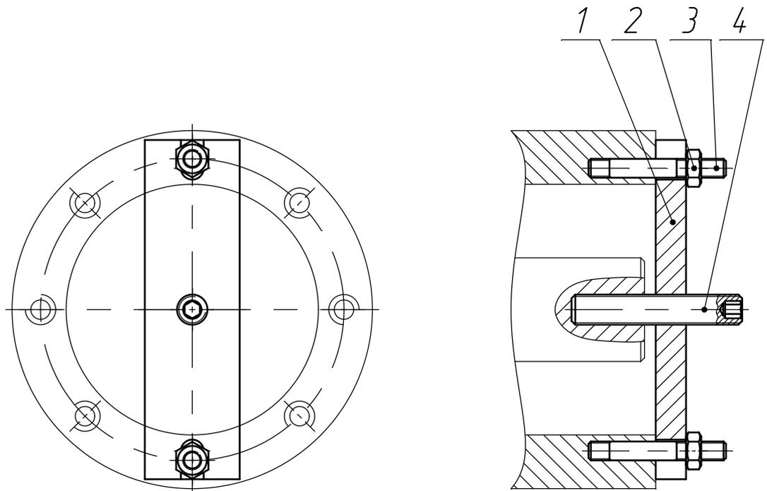
Рисунок 5 - Приспособление для демонтажа ведущего винта
